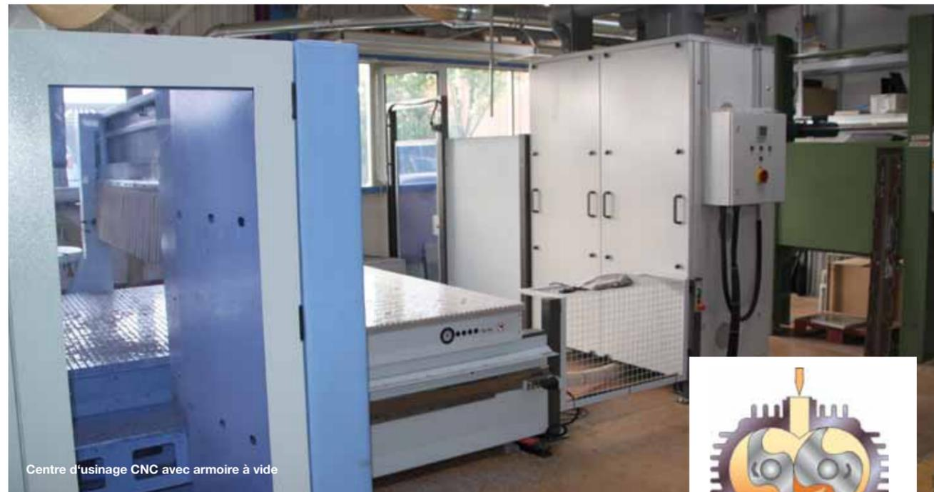
Centre d'usinage CNC avec armoire à vide
