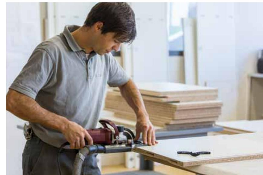
permettent, la rainure profilée peut aussi être fraisée avec la machine portable Zeta P2.
