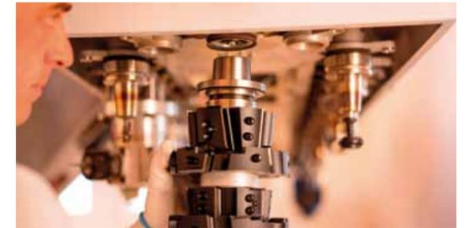
Le ProfilCut Q Premium est l'outil de profilage le plus rapide de la branche et qui offre aussi des avantages en termes de qualité d'usinage. Par ailleurs, le fait que les couteaux puissent être remplacés dans le jeu d'outils monté, est également une caractéristique distinctive de ce système d'outil. (Photo: Leitz)
