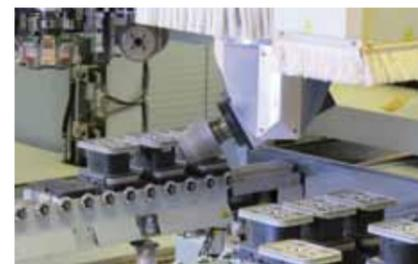
La construction particulière en forme de cône tronqué permet le fraisage impeccable de longs chanfreins sur la machine à 5 axes. La hotte aspirante évacue la totalité des copeaux.
