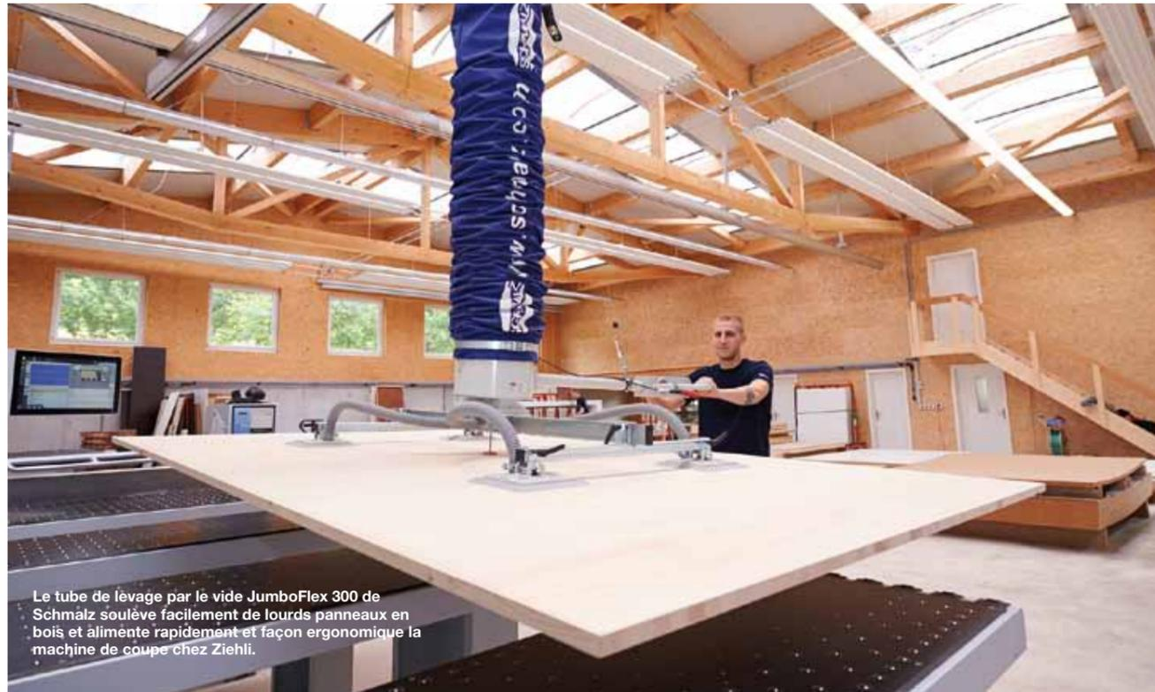
Le tube de levage par le vide JumboFlex 300 de Schmalz soulève facilement de lourds panneaux en bois et alimente rapidement et façon ergonomique la machine de coupe chez Ziehli.
