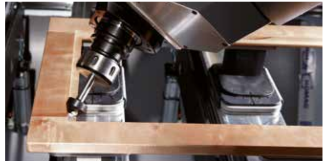
Fresatura ad angolo retto per la battuta del vetro
