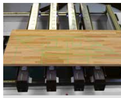
Proiezione laser dei dispositivi di bloccaggio e del contorno del pezzo per un utilizzo ottimale e un facile posizionamento di pezzi grezzi che non possono essere allineati contro i perni di battuta.
