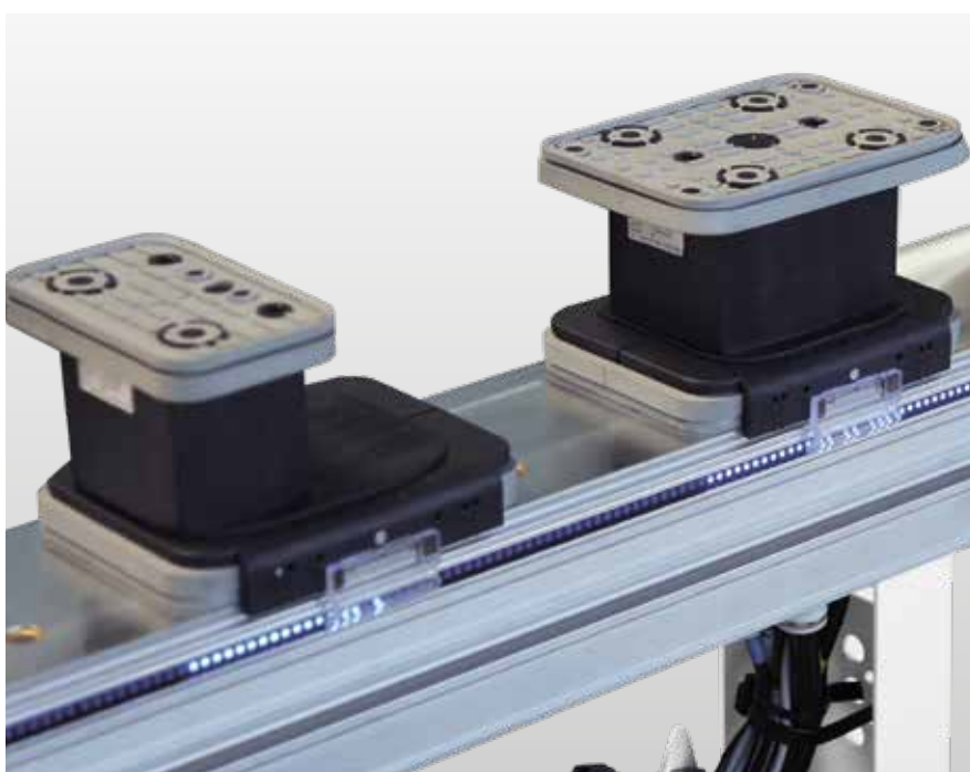
Sistema di posizionamento a LED (opzione) Le luci a LED indicano all'operatore esattamente la posizione, l'orientamento e le dimensioni delle ventose, nonché la posizione delle traverse → per un posizionamento fino al 70% più veloce
