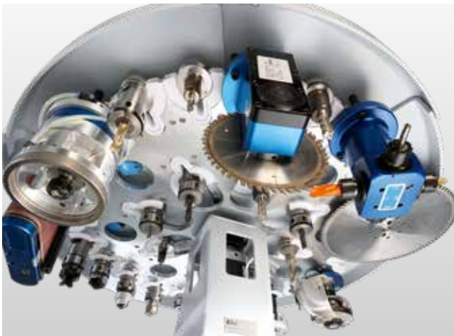
Cambiador de platos de 32 posiciones: disposición de las herramientas en un anillo interior y un anillo exterior. Para herramientas y grupos con un diámetro de hasta 200 mm y una hoja de sierra con un diámetro de hasta 350 mm (en el anillo exterior).
