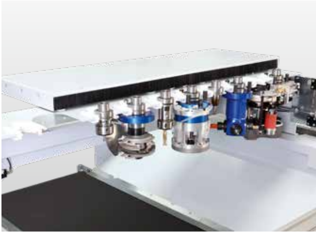
Cambiador lineal de 8 posiciones con puesto de traspaso de la herramienta montado en el lateral. Otra opción es el puesto de Pick-Up para el grupo easyEdge integrado.
