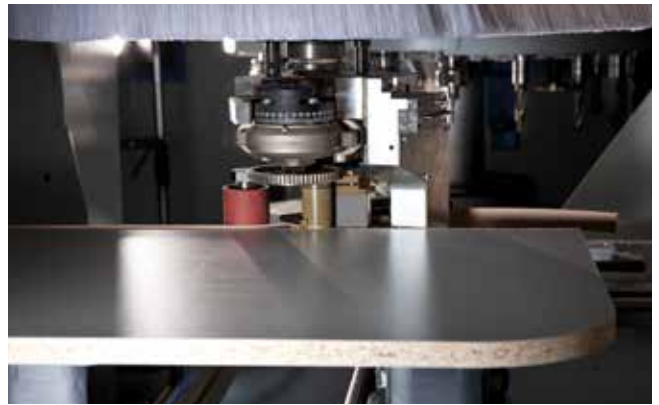
Grupo de encolado easyEdge para un encolado eficiente de las piezas moldeadas
