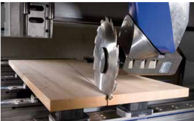
Cortes de separación hasta una altura de 110 mm
