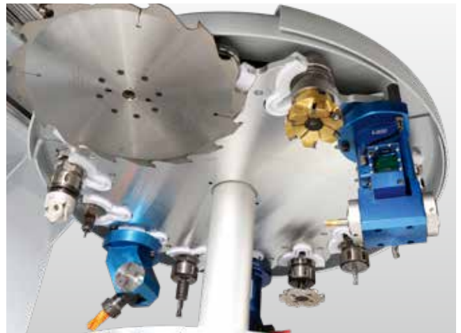
Cambiador de platos de 14 posiciones para herramientas y grupos con un diámetro de hasta 200 mm y una hoja de sierra con un diámetro de hasta 350 mm.
