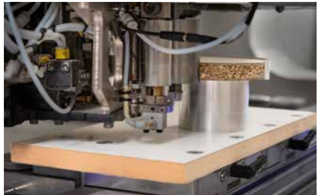
Encolado de cantos de 360° con grupo de encolado de cantos powerEdge Pro Duo
