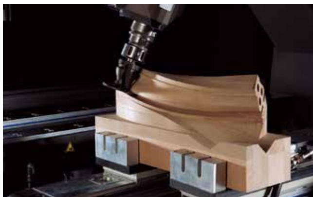
Fresado del pasamanos de las escaleras
