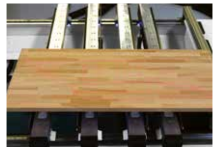
Proyección láser de los medios de fijación y del contorno de la pieza para un aprovechamiento óptimo y una colocación sencilla de las piezas en bruto que no se pueden alinear con los topes.
