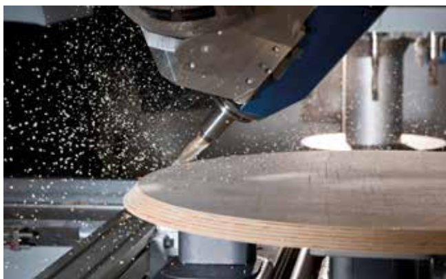
Fresado del bisel en una placa de la mesa
