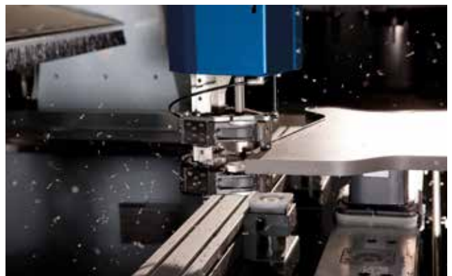
Acabado perfecto de los cantos a través de la combinación del grupo repulidor y de fresado a ras explorado
