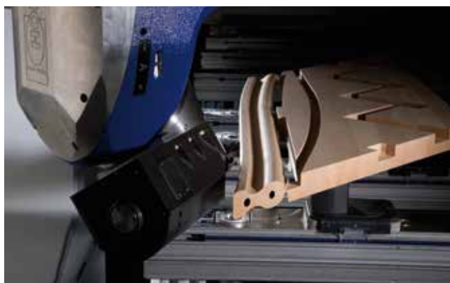
Perforaciones de palés en ángulo estrecho
