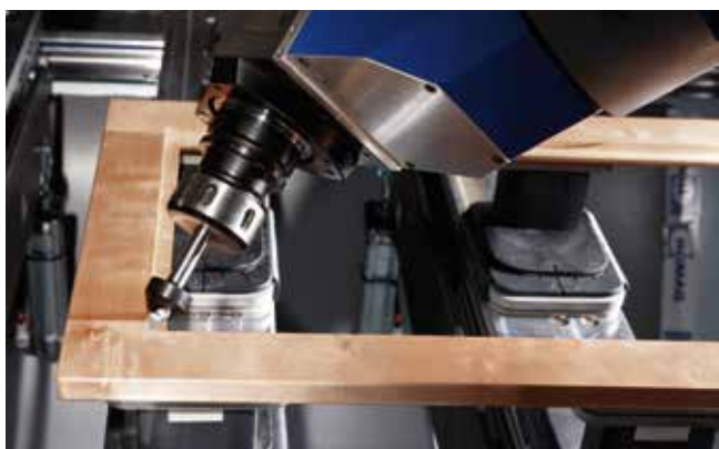
Recorte en ángulo de una esquina para rebajo de vidrio
