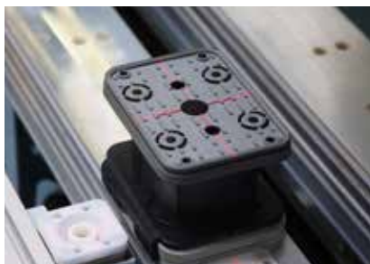
Posicionamento LASER – Sapatas com ventosas são marcadas com uma cruz de laser. O contorno da peça pode ser “movido” para ajudar no posicionamento de peças de contornos livres.
