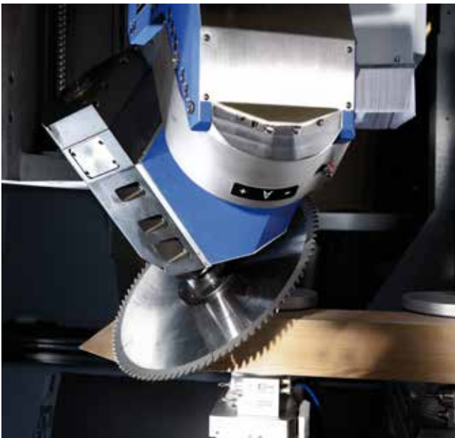
DRIVE5CS/C+ cabeçote de fresagem de 5 eixos com desempenho de 10 kW (opcional 12 ou 15 kW) e uma rotação controlada do eixo de até 24 000 1/min para um torque elevado mesmo em baixas velocidades.
