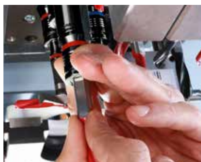
Sistema de troca rápida O sistema de troca rápida patenteado para a troca da broca sem ferramentas reduz o tempo de setup.
