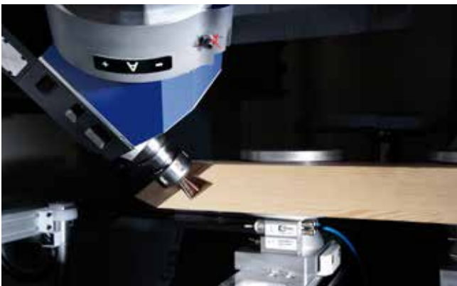
Usinagem rabo de andorinha para produção de móveis e componentes
