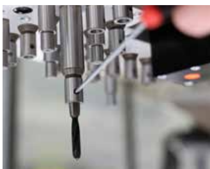
Sistema de troca Weldon para uma troca de broca com ferramentas
