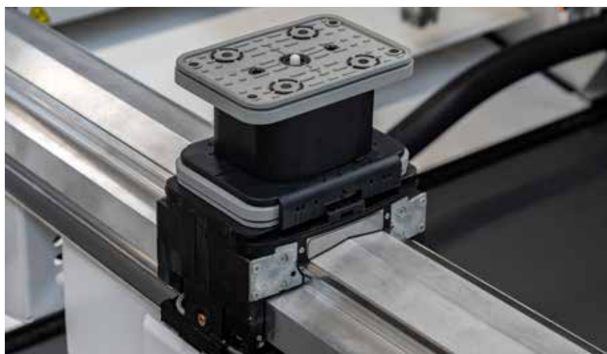
Grampo a vácuo com válvula de apalamento – ventosas não ocupadas podem permanecer na plataforma. Altura de montagem de 100 mm
