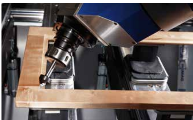
Usinagem de quinas para rebaixo de janela
