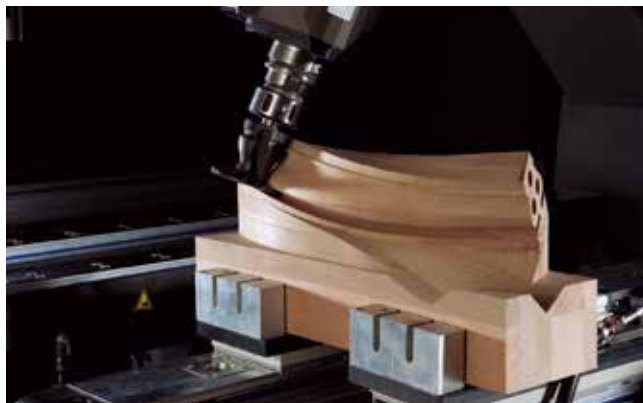
Usinagem de corrimão de escadas
