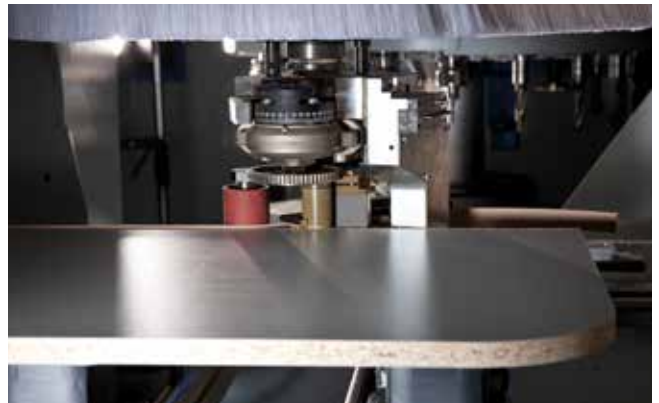
Grupo de colagem easyEdge para a colagem eficiente em peças com curvas
