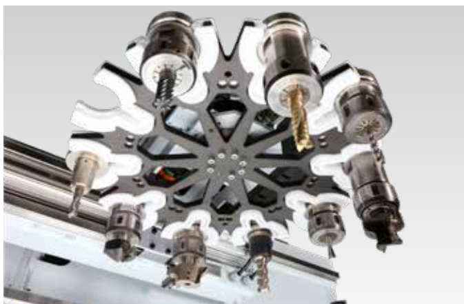
Magazzino circolare a 10 posizioni mobile sul mandrino. Cambio utensili durante la foratura o la bordatura. Per utensili ed aggregati con un diametro fino a 180 mm.
