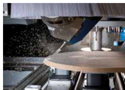
Fresatura dello smusso su un piano del tavolo
