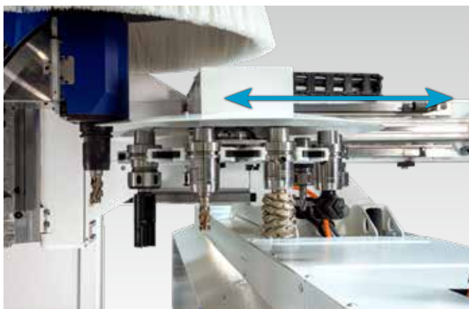
Magazzino circolare a 10 posizioni mobile sul mandrino. Cambio utensili durante la foratura o la bordatura. Per utensili ed aggregati con un diametro fino a 180 mm.
