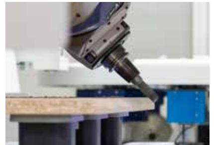
Refilatura con tastatura della sporgenza del bordo sul profilo di postforming
