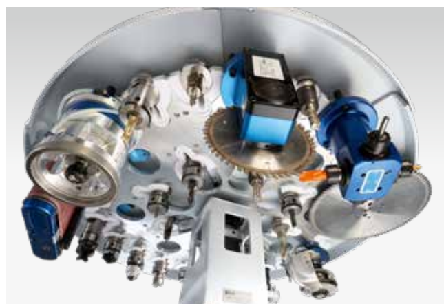
Magazzino circolare a 32 (24) posizioni per la disposizione degli utensili in un anello interno e in uno esterno. Per utensili ed aggregati con un diametro fino a 200 mm e una lama con un diametro fino a 350 mm (nell'anello esterno).
