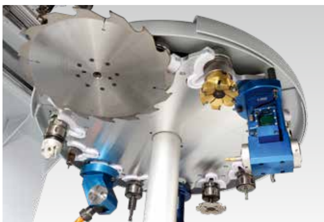
Magazzino circolare a 14 posizioni per utensili ed aggregati con un diametro fino a 200 mm ed una lama fino a 350 mm.
