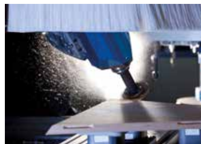
Fresatura di scanalature oblique per una giunzione pannelli
