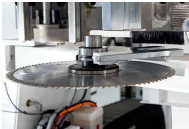
La posizione Pick-up aggiuntiva per lame con diametro fino a 350 mm consente di risparmiare posizioni nel magazzino cambio utensili. Combinabile liberamente con altri magazzini cambio utensili.
