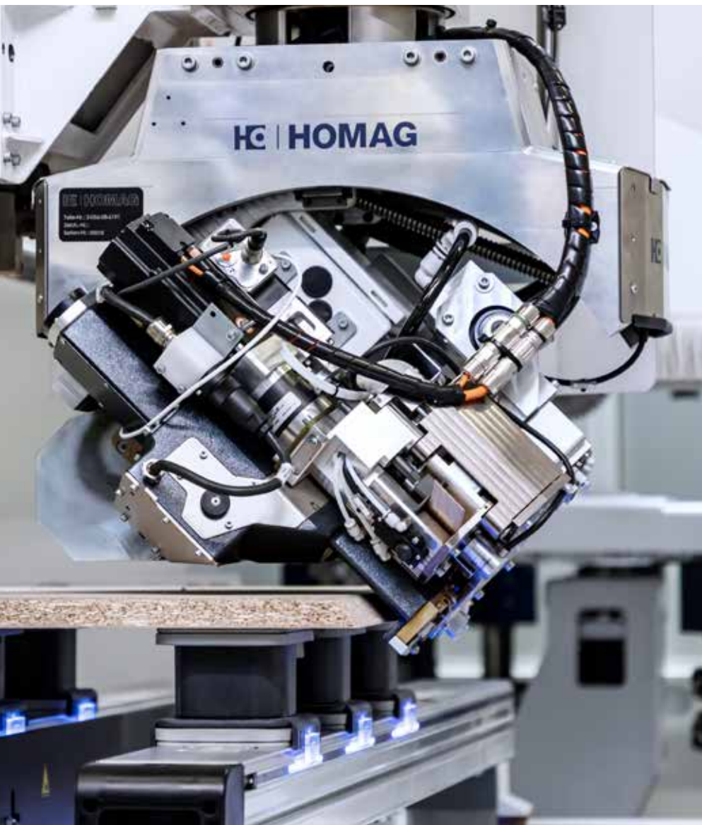
Incollaggio dei bordi obliqui
