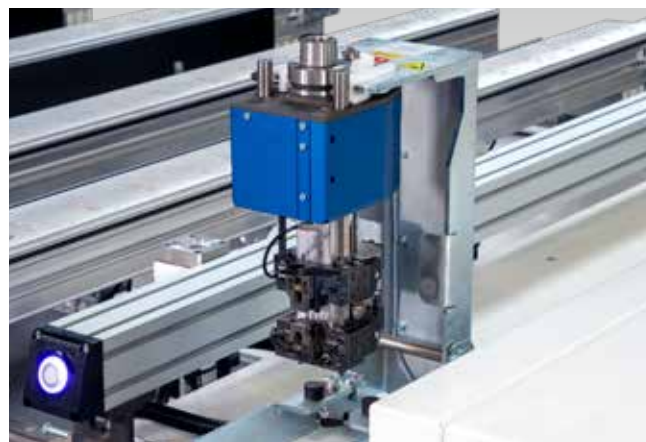
La posizione cambio utensili aumenta il comfort d'utilizzo ed evita errori durante l'attrezzaggio delle posizioni del magazzino, per una maggiore sicurezza.
