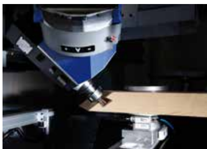
Fresatura di giunzioni tra montanti e traverse
