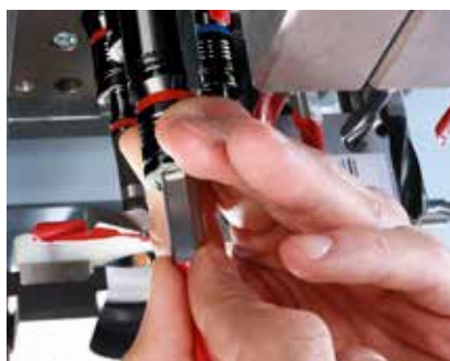
Sistema di cambio rapido brevettato per un cambio delle punte senza utensili per ridurre i tempi di attrezzaggio.
