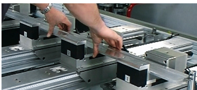
Elementi di bloccaggio speciali per la lavorazione dell'alluminio
